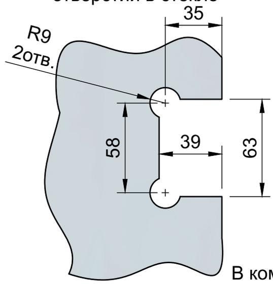
В комплекте прокладки для стекла 8 мм, 10 мм, 12 мм
