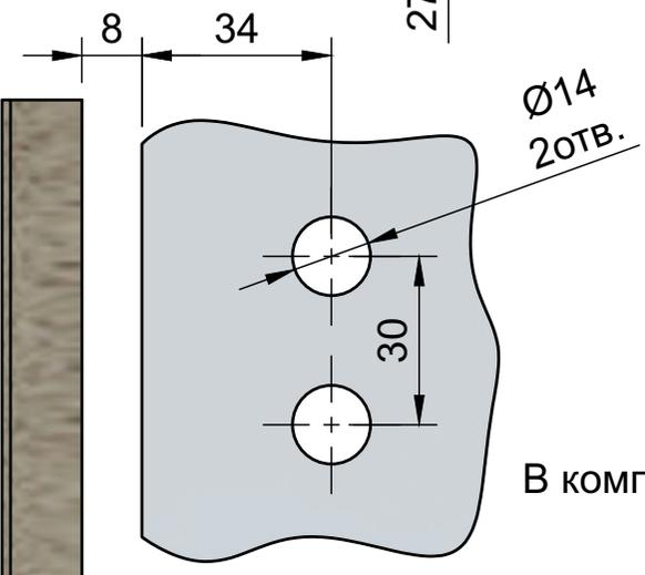
В комплекте прокладки для стекла 6 мм, 8 мм, 10 мм
