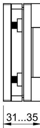
Эскиз установочных отверстий в стекле
