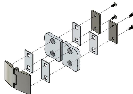
В комплекте прокладки для стекла 6 мм, 8 мм, 10 мм
